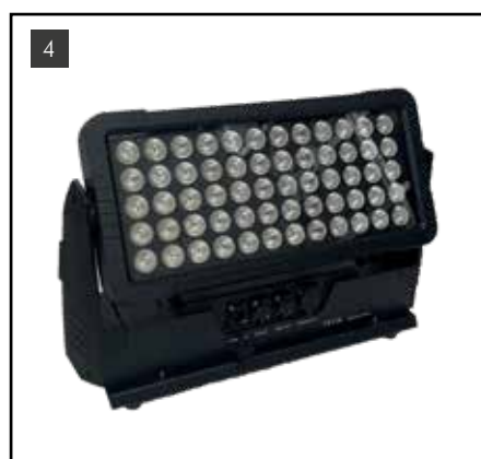
4 STRAHLER LED PROLINE Aluminiumgehäuse schwarz, RGBW-Farben/ 4 in 1 LED – separat ansteuerbare Lichtreihen, Lichtquelle 60x10 Watt, control mode: DMX512, 650 Watt, IP65, Master-/Slave-Modus, Maße HxBxT, Preise per Stück 01| 9106162- 35x55x15 cm € 949,00
